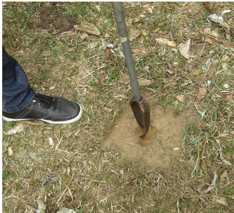
Figura 2 – Coleta no Parque “da Cidade” Joventino Silva utilizando um trado tipo holandês.
